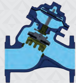
Modo de apertura con el A Port
